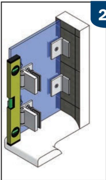
Die Zapfen der Gegenplatten mittig im Glasausschnitt positionieren, um den grösstmöglichen Verstellbereich für die Einstellung der Dusche zu gewährleisten. | The entry pilot of the counter plate should be focus central in the glass part to maximize the setting range for adjustment of the shower.
