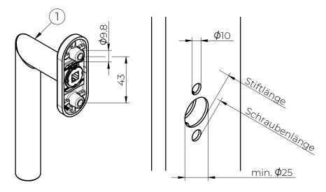
Sollte das Befestigungsloch grösser als 10mm sein, so müssen Reduktionshülsen Gr. 9.5x11.5mm 902100032 BE 100997 eingesetzt werden.
