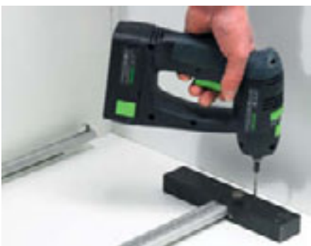
1) Bei der Entwicklung von Easys wurde besonderer Wert auf die einfache Montage gelegt. Mit der Easys Korpusbohrlehre sind die Befestigungslöcher leicht positioniert.
