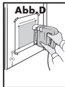
2. Bohren Sie vier Ecklöcher, wie auf der Schneideschablone markiert ist, mit einem Bohrer mit 12 mm Durchmesser durch die Tür. Stellen Sie bitte sicher, dass der Bohrer gerade und waagrecht bleibt.
