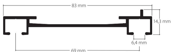
**2-Lauf Vorhangprofil «maxi», Norm VS57 für die Sicht-Montage mit Drehteller**
