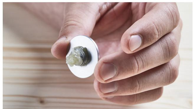
Vor Kontakt mit Klebstoff schraubbare Verbindungen mit Trennmittel Collano HP 2000 einreiben.
