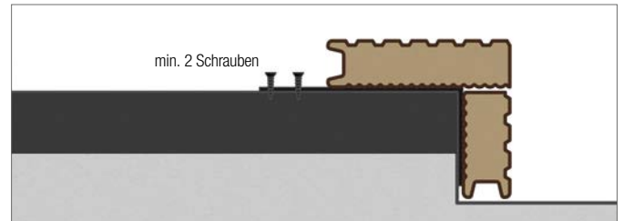
2. Fixierung Befestigungswinkel mit Unterkonstruktion
