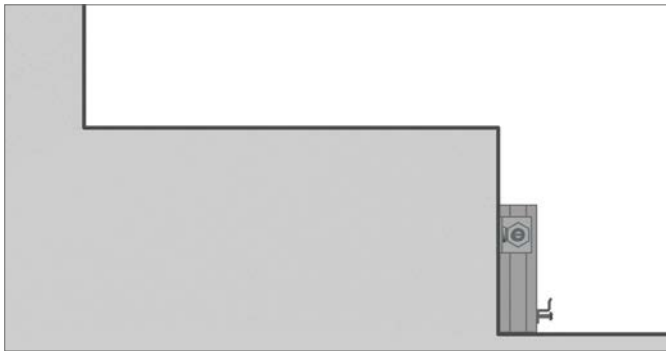
1. Montage der Unterkonstruktion und der Endklammer
