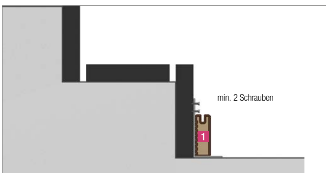
3. Fixierung Befestigungswinkel mit Unterkonstruktion
