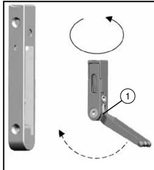
Der MULTI-Vent muss auf rechts bzw. links eingestellt werden, damit die Inbusschraube ① zur Einstellung der Bremswirkung erreichbar ist.
