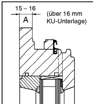
Wenn das **Maß A** (Überschlagshöhe) größer ist als 16 mm, muss die mitgelieferte KU-Unterlage ② unter den Verschlusshaken montiert werden.
