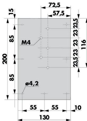
Montageplatte für den Haken der Türdämpfer H 1300 bei schmalen Stahlzargen
