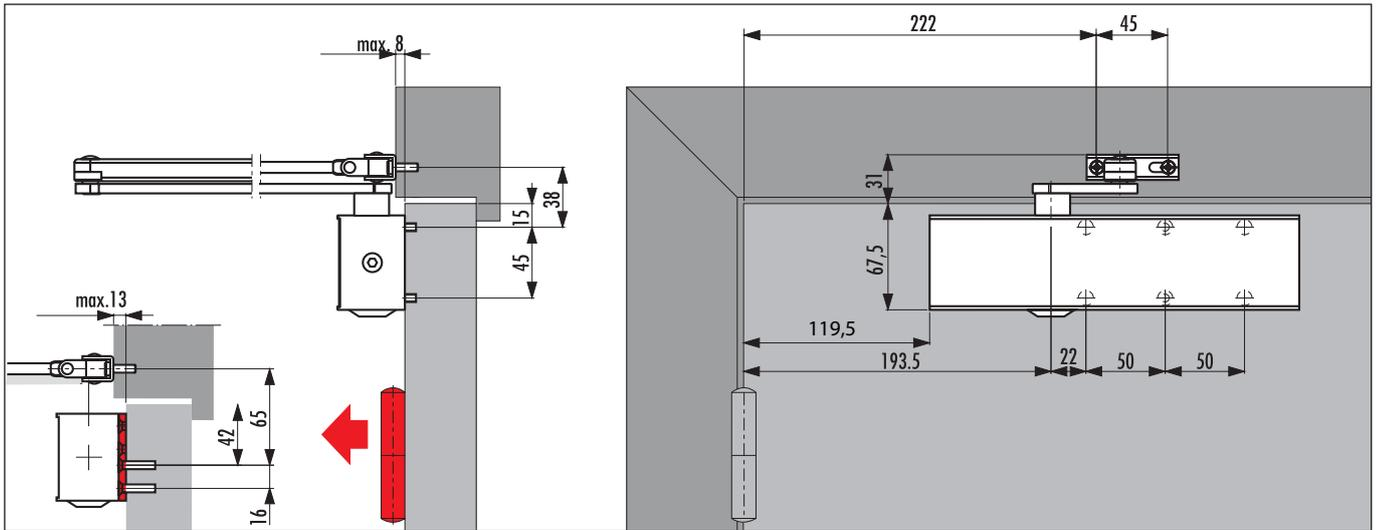
TS 73 V Türblattmontage mit Rastfeststellarm
