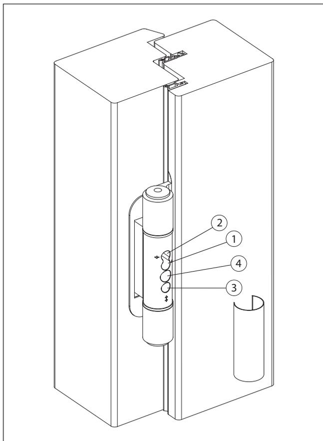
Il sistema Easy 3D per portoncini in legno, permette 3 regolazioni (laterale, in altezza e in profondità) agendo direttamente sul corpo centrale della cerniera.
