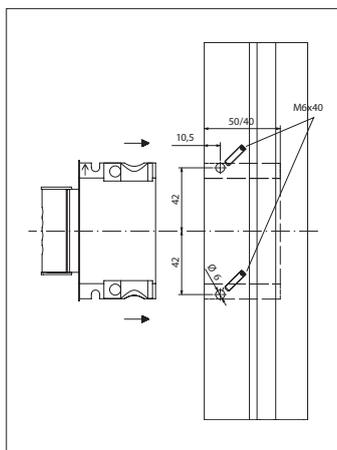
Inserire la tasca nella fresatura con la stampiglia attraverso l'alto e fissarla nel telaio con le viti in dotazione M6x40.
