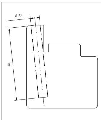
Effettuare la foratura o manualmente con dima con CNC.
