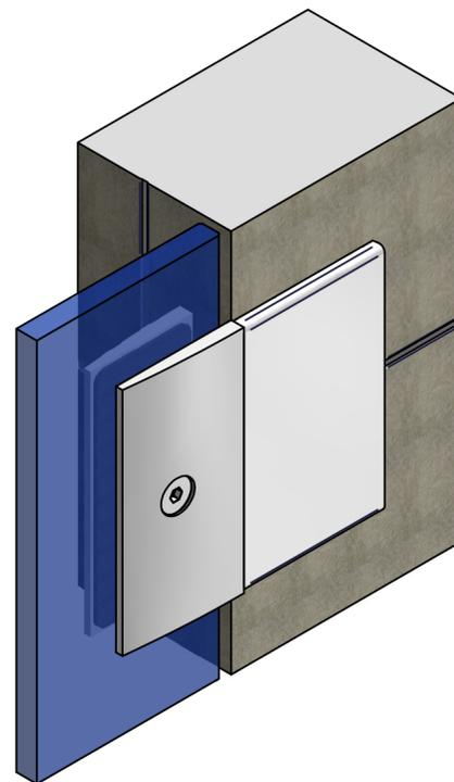
Aufsetzen des Seitenteils auf den Wannen- bzw. Duschtassenrand mit den vormontierten Längsverbindern um die Position der Bohrungen für die Wandlaschen anzuzeichnen.
