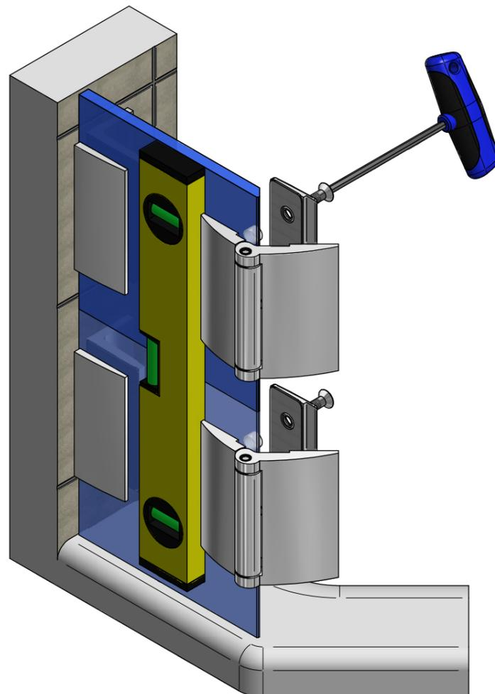
Die Zapfen des Beschlages mittig in den Glasbohrungen positionieren, um den größtmöglichen Verstellbereich für die Einstellung der Dusche zu gewährleisten. Um den späteren Abstand für die untere Dichtungslösung sicherzustellen, sollte der Türflügel mit Montageklötzen in der Höhe des beabsichtigten Abzugsmasses unterklotzt werden.
