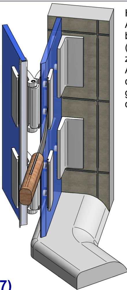
Hinweis zur Demontage der Abdeckkappen. Führen Sie bitte eine stabile, breite Klinge (z.B. Bleimesser) in den Spalt zwischen Gegenplatte und Abdeckkappe ein und hebeln die Abdeckkappe unter gleichzeitigem Nachführen des Messers ab.
