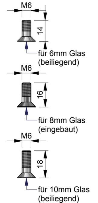
Wechselweise bis zum Erreichen des max. Anzugsmomentes von 10N·m anziehen.
