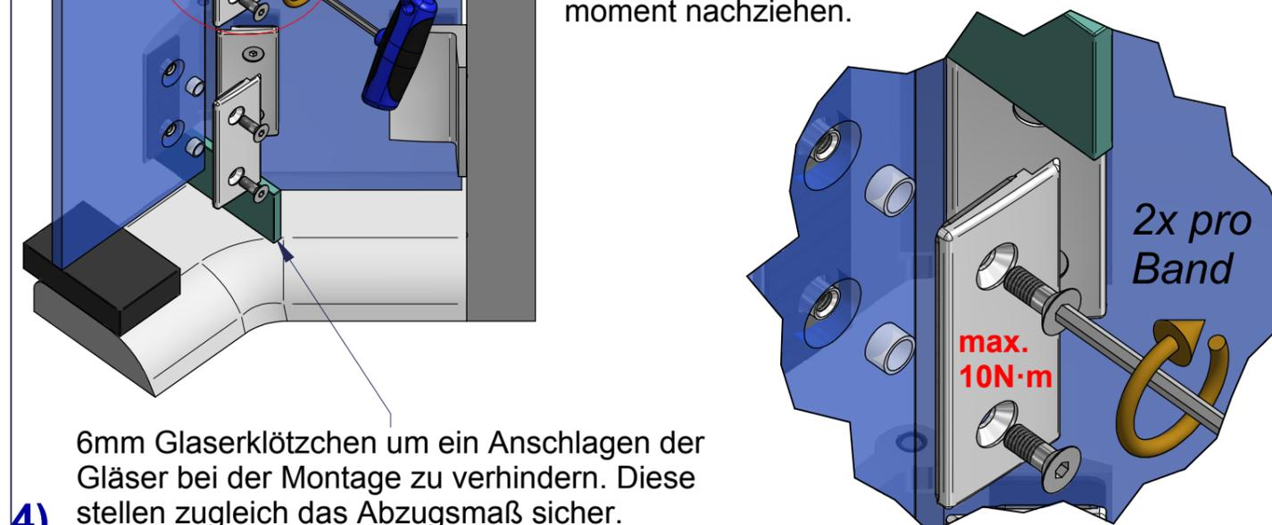
6mm Glaserklötzchen um ein Anschlagen der Gläser bei der Montage zu verhindern. Diese stellen zugleich das Abzugsmaß sicher.
