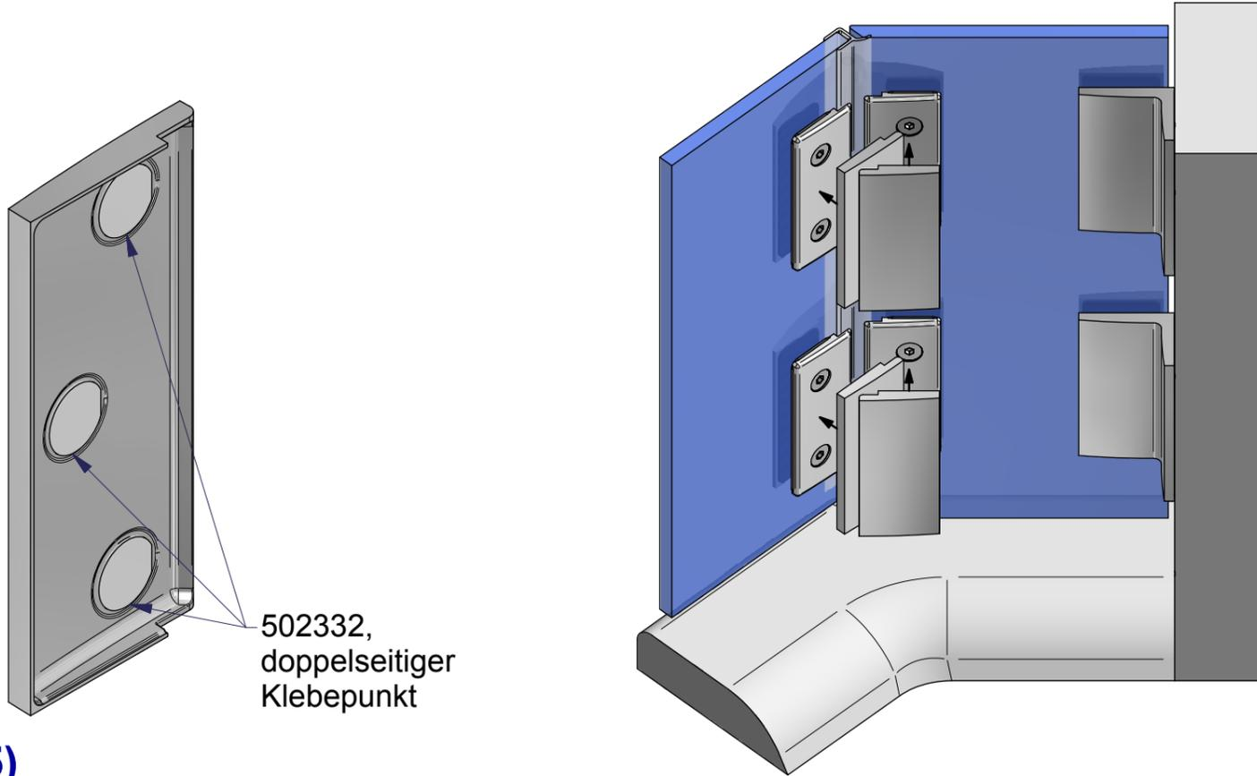
Glasbearbeitung für 8mm Glas mit Dichtprofil 8860KU0-8
