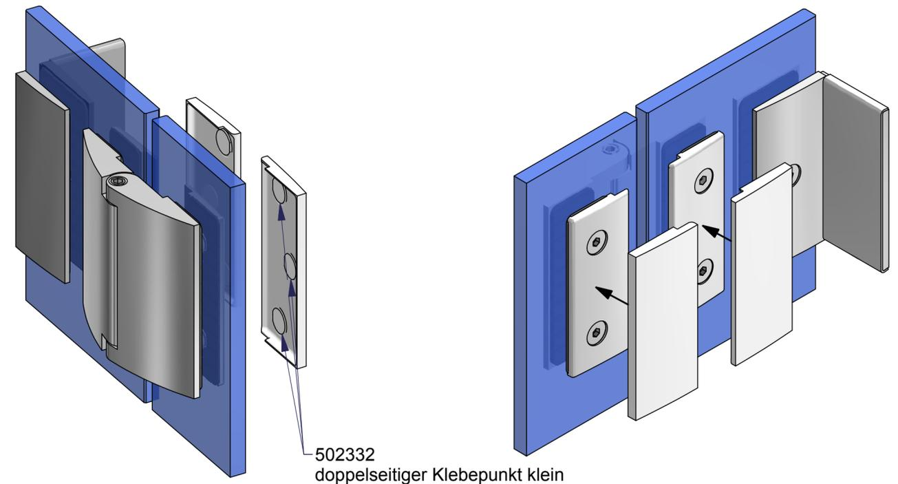
Hinweis zur Demontage der Abdeckkappen. Führen Sie bitte eine stabile, breite Klinge (z.B. Bleimesser) in den Spalt zwischen Gegenplatte und Abdeckkappe ein und hebeln die Abdeckkappe unter gleichzeitigem Nachführen des Messers ab.
