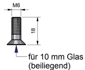
Wechselweise bis zum Erreichen des max. Anzugsmomentes von 10N·m anziehen. Nach ca. 15 Minuten nocheinmal wechselseitig auf das max. Anzugsmoment nachziehen.
