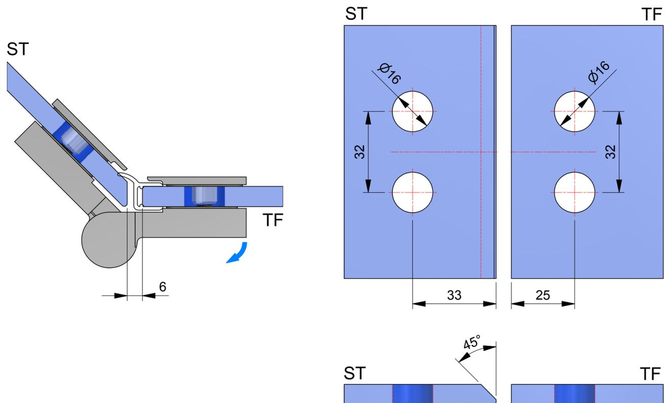
Glasbearbeitung für 8mm Glas mit Dichtprofil 8861KU0-8 (rechts montiert)
