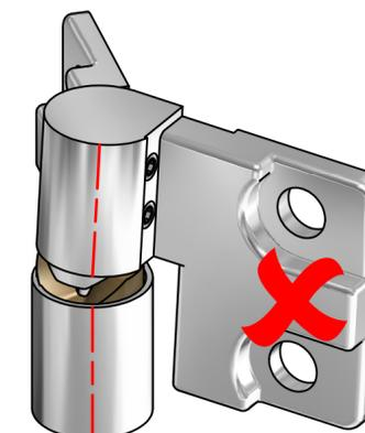
Achten Sie bei der Montage bitte darauf, daß bei beiden Bändern die Flügelteile auf den Festteilen aufliegen. Dadurch wird das Türflügelgewicht von beiden Bändern getragen.
