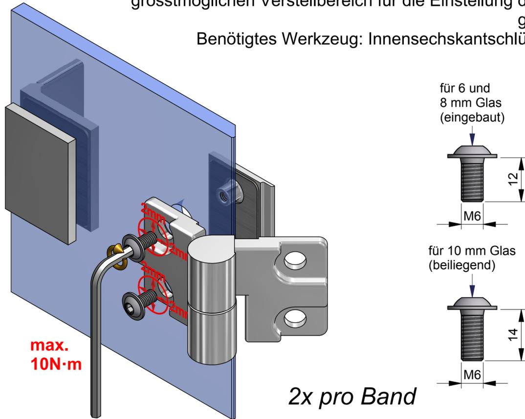
2) Wechselweise bis zum Erreichen des max. Anzugsmomentes von 10N·m anziehen.
