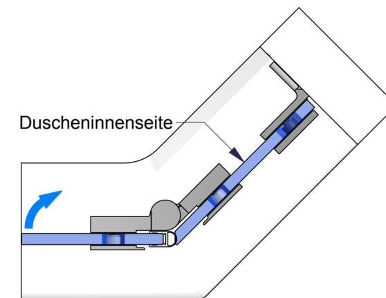
Bitte achten Sie vor der Montage bei allen Nivello- und Nivello+-Duschbändern darauf, daß die beiden Gewindestifte zur Nulllageneinstellung weit genug heraus gedreht sind und keinen Kontakt zu den inneren Bauteilen der Nulllageneinstellung haben.
