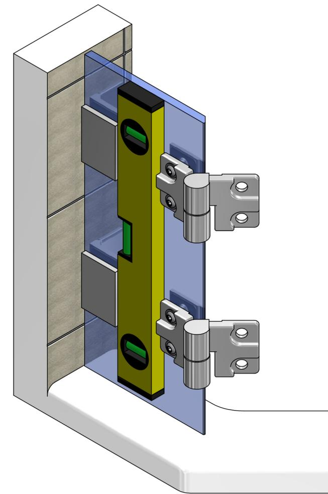
Die Befestigungsschrauben mittig in den Bohrungen positionieren, um den grösstmöglichen Verstellbereich für die Einstellung der Dusche zu gewährleisten.
