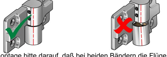
Achten Sie bei der Montage bitte darauf, daß bei beiden Bändern die Flügelteile auf den Festteilen aufliegen. Dadurch wird das Türflügelgewicht von beiden Bändern getragen.
