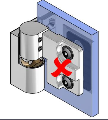
Bitte achten Sie vor der Montage bei allen Nivello- und Nivello+-Duschbändern darauf, daß die beiden Gewindestifte zur Nulllageneinstellung weit genug heraus gedreht sind und keinen Kontakt zu den inneren Bauteilen der Nulllageneinstellung haben.
