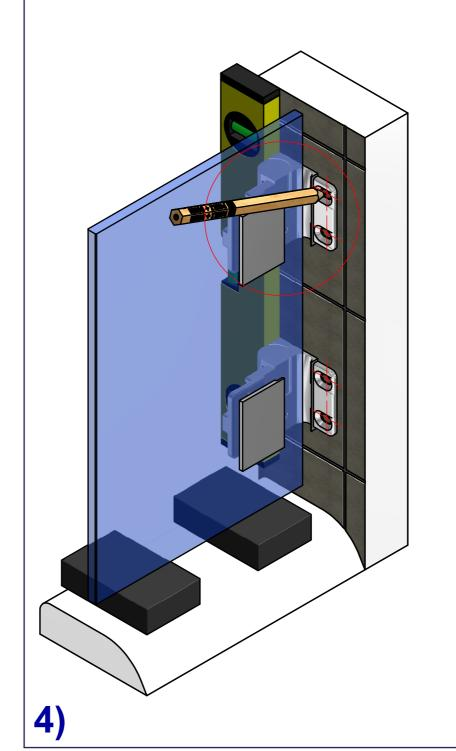
Aufsetzen des Seitenteils auf den Wannen- bzw. Duschtassenrand mit den vormontierten Bändern um die Position der Bohrungen für die Wandlaschen anzuzeichnen.
