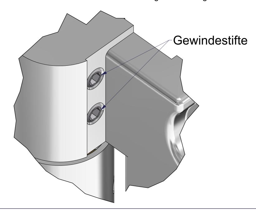
Die Befestigungsschrauben mittig in den Bohrungen positionieren, um den grösstmöglichen Verstellbereich für die Einstellung der Dusche zu gewährleisten. Benötigtes Werkzeug: Innensechskantschlüssel SW4mm
