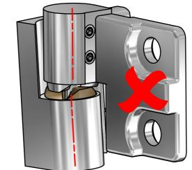
Beim Anzeichnen und bei der Montage an der Wand drücken Sie bitte immer bei beiden Bändern die Wandlasche gegen das Flügelteil hoch. Dadurch wird das Türflügelgewicht
