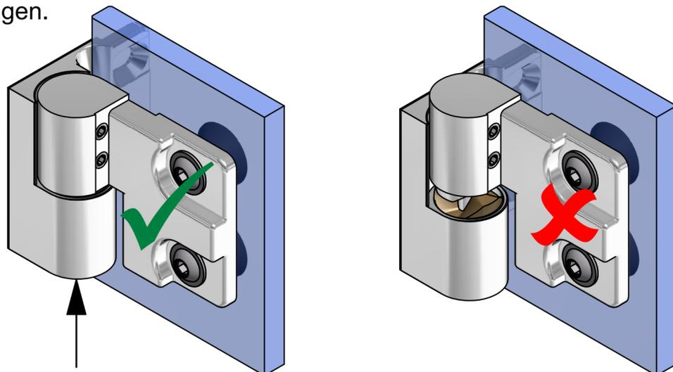
Die Befestigungsschrauben mittig in den Bohrungen positionieren, um den grösstmöglichen Verstellbereich für die Einstellung der Dusche zu gewährleisten. Benötigtes Werkzeug: Innensechskantschlüssel SW4mm
