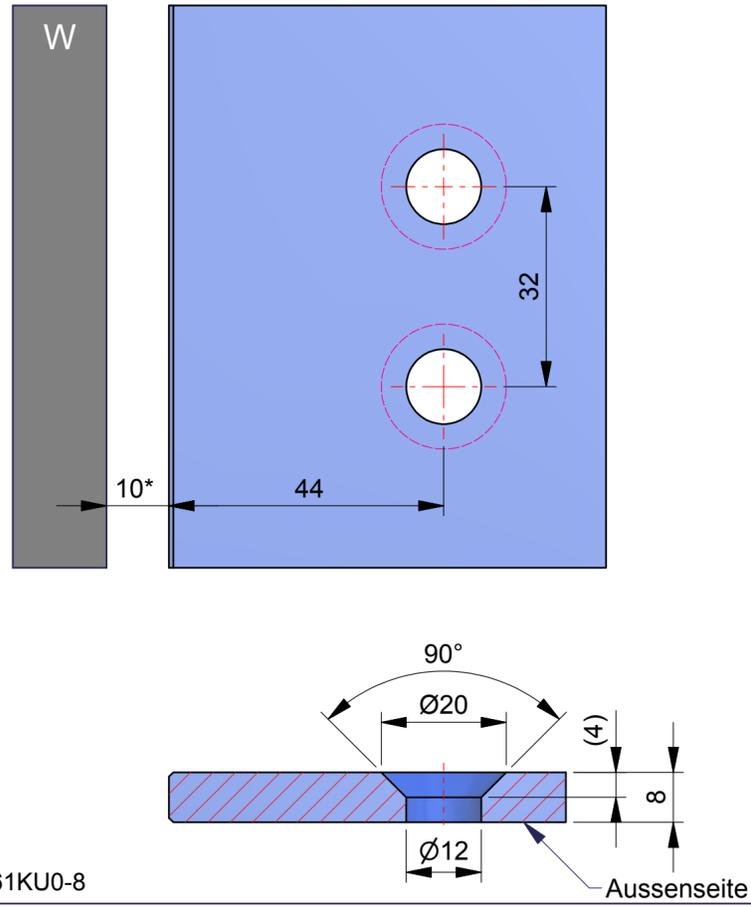
\* bei Verwendung von Dichtprofil 8861KU0-8
