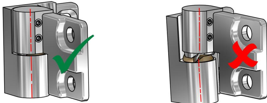
Beim Anzeichnen und bei der Montage an der Wand drücken Sie bitte immer bei beiden Bändern die Wandlasche gegen das Flügelteil hoch. Dadurch wird das Türflügelgewicht von beiden Bändern getragen.
