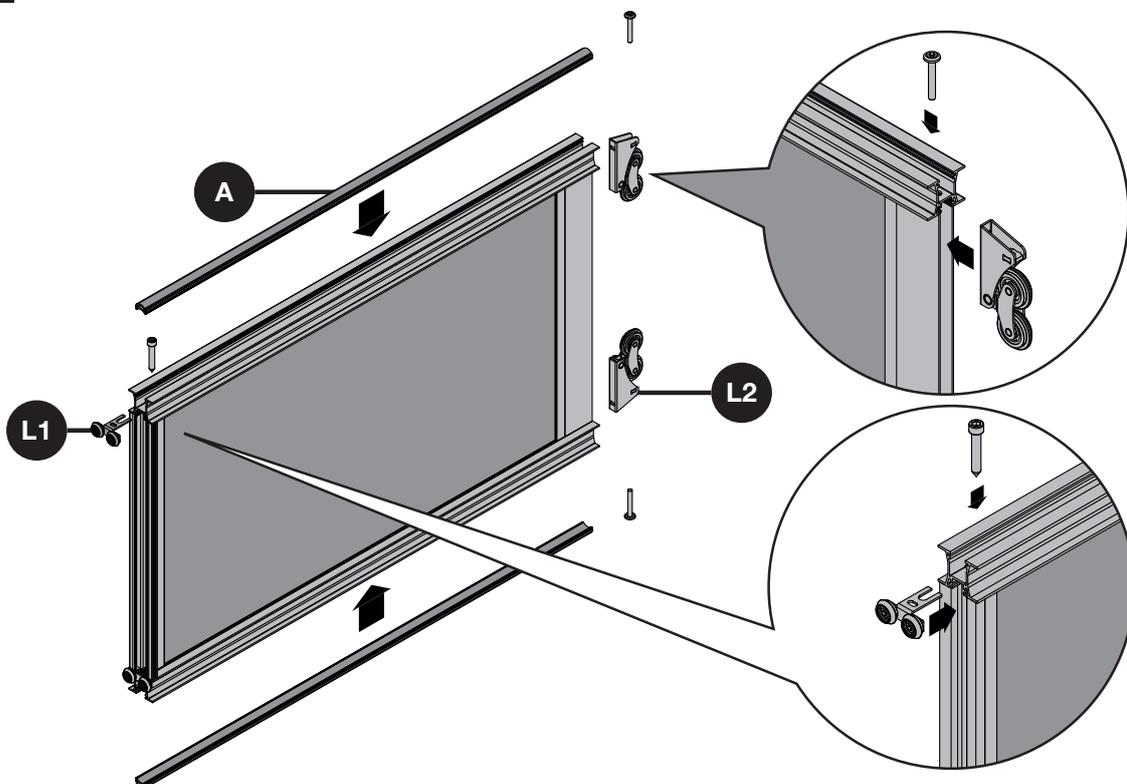
**i** (L1) Laufrollen oben, (L2) Laufrollen unten, Anschlagdichtung (A) (kann konkav oder konvex eingezogen werden.)
