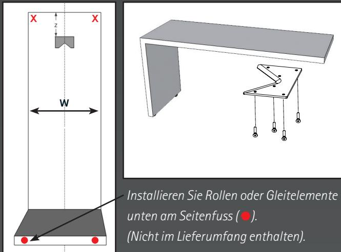
Installieren Sie Rollen oder Gleitelemente unten am Seitenfuss (●).
