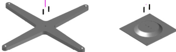
Stifte  $\varnothing 6 \times 20 \text{mm}$  in Kopfplatte einsetzen
