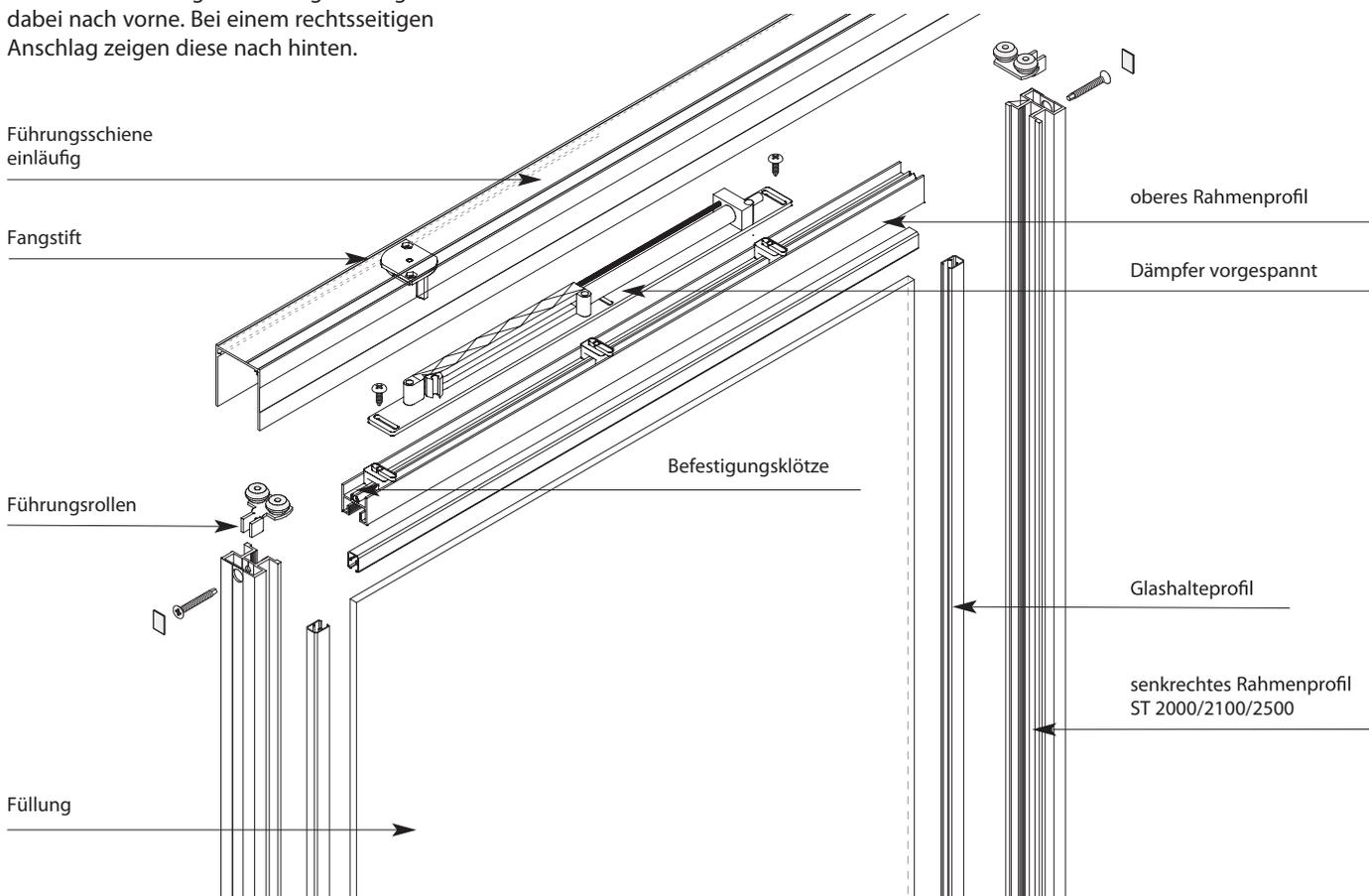
Dämpfer bei zweiläufigen Schiebetüranlagen
