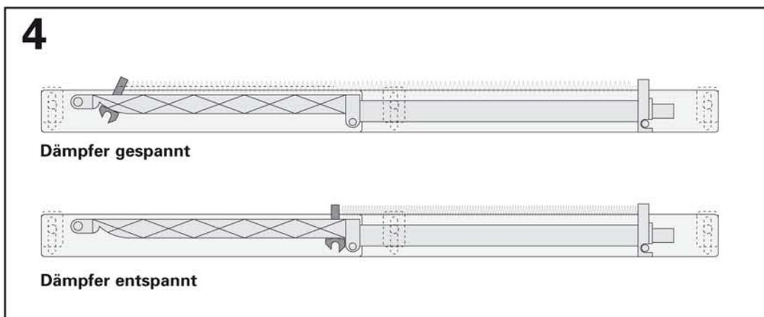
**4 - Vorspannen des Dämpfers und Einheben der Schiebetür**
