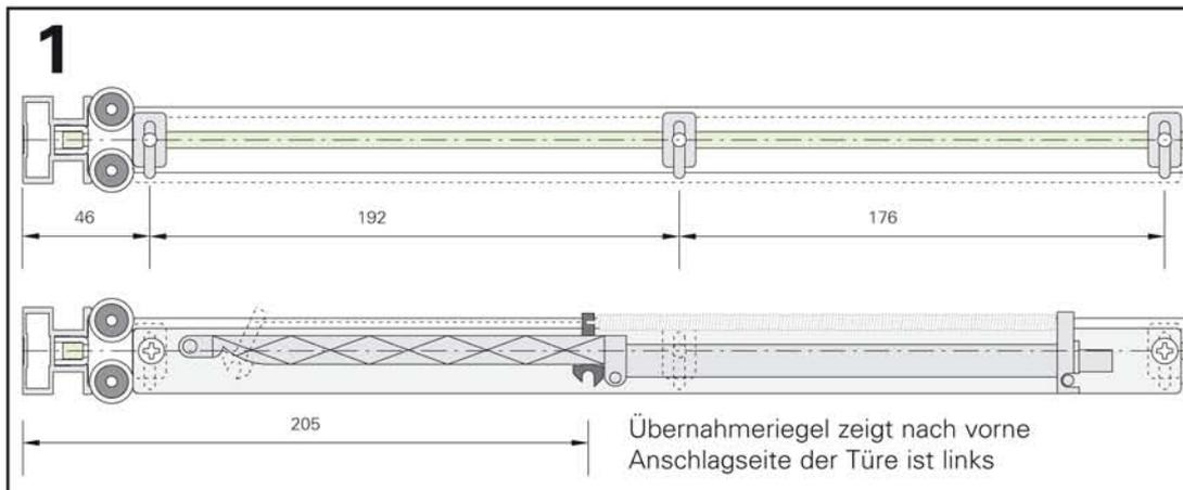
**1 - Montage des Dämpfungssystem auf dem oberen Rahmenprofil**
