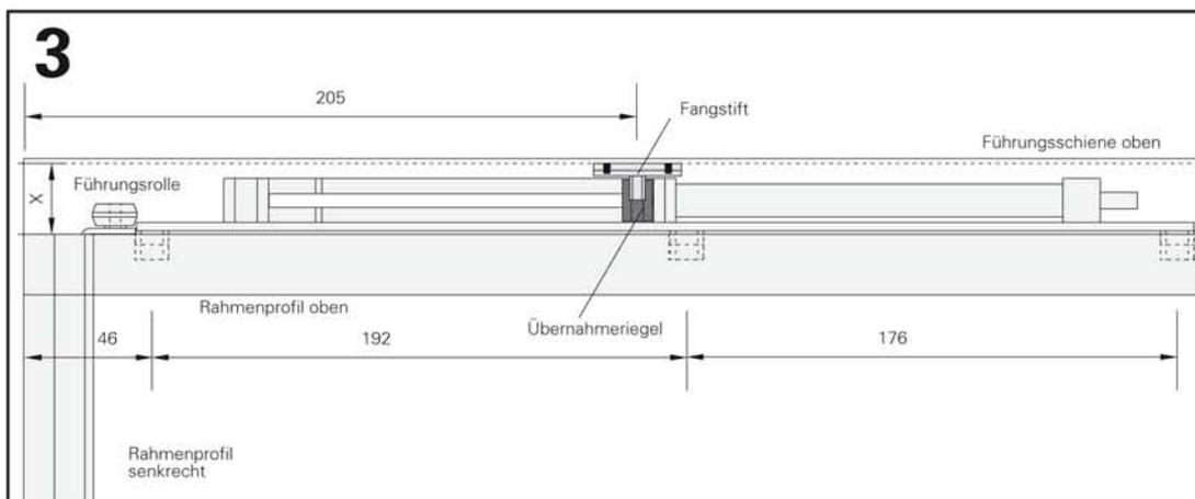
**3 - Kürzen des Fangstift nach dem ermittelten Maß und Einbau ins Führungsprofil**
