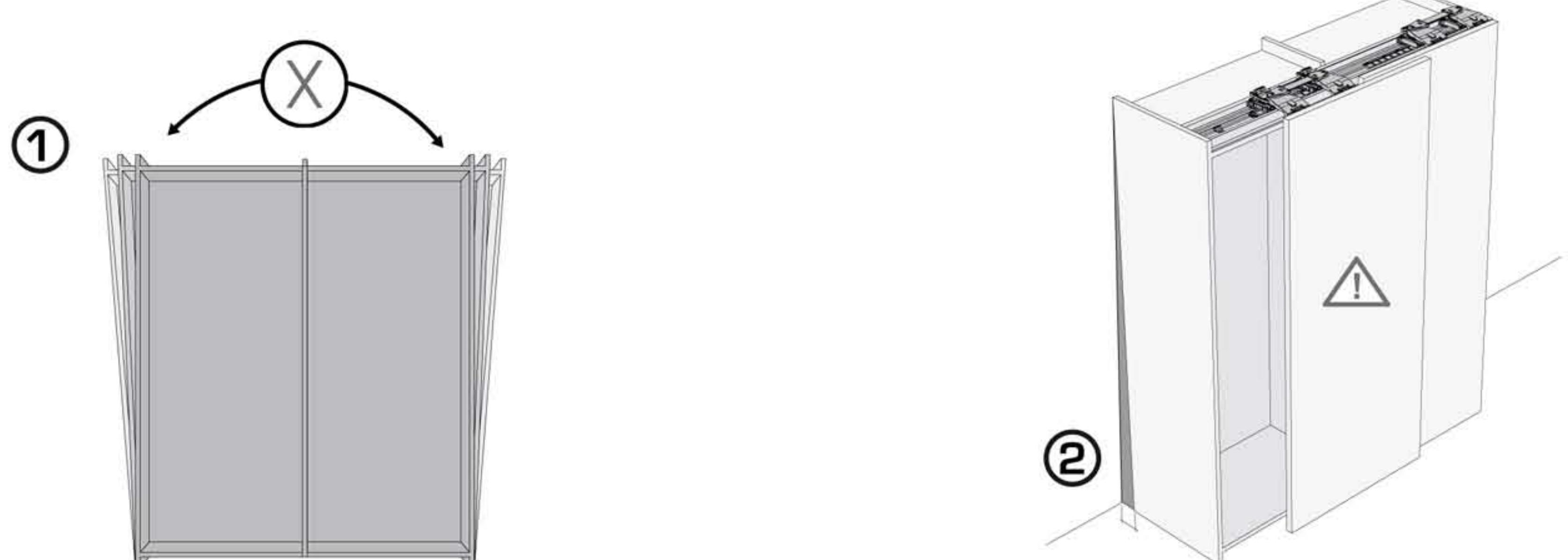
Livellare l'armadio, garantendo una stabilità al mobile (dis. 1) - Per ante di grandi dimensioni ancorare il mobile alla parete con una leggera inclinazione (dis. 2)
