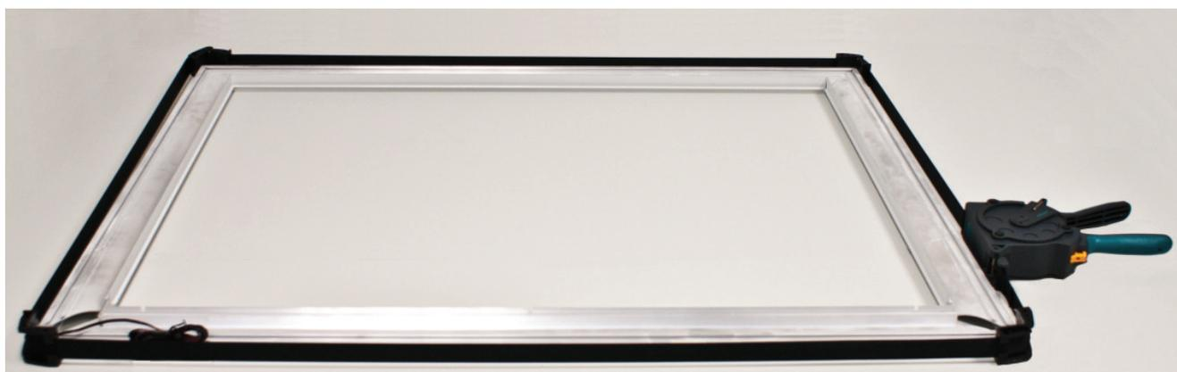
Spanngurt um den Rahmen legen und so anziehen, dass in den Ecken kein Spalt zu sehen ist
