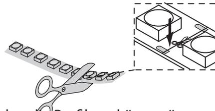
Werden die Profile gekürzt müssen die LED Bänder angepasst werden. Alle 50mm ist dies möglich. Auf das Scherensymbol achten.
