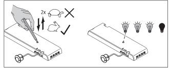
Der Sensor registriert Bewegungen im Abstand von maximal ca. 2,5 m und schaltet das Licht automatisch an. Das Licht bleibt solange an, wie eine Bewegung erfasst wird. Nach der eingestellten Abschaltverzögerung (s. o.) erlischt das Licht wieder (wenn zwischenzeitlich keine Bewegung registriert wird).
