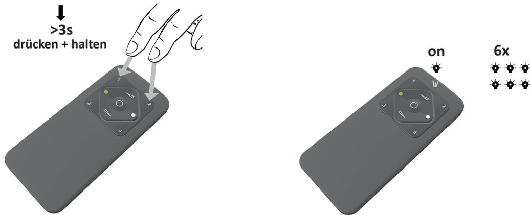
Durch Drücken und Halten der Speichertasten a & b versetzen Sie den Sender in den Einlern-Modus. Der erfolgreiche Start wird mit schnellem Blinken der roten Anzeige-LED bestätigt. Bei gelungener Anbindung blinkt die Rote LED 6 Mal. Die erfolgreiche Verbindung wird auch durch Blinken der angeschlossenen LED Leuchte bestätigt.
