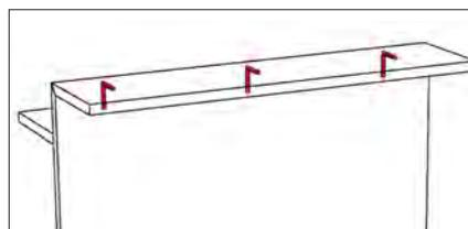
**Barthecken** - Der Winkeldübel dient gleichzeitig auch zur Positionierung der Bauteile.
