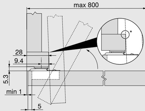
Scharniermaße und Fugenberechnung bei Werkseinstellung
