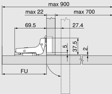
Scharniermaße bei Werkseinstellung (Montageplatten-Distanz = 0 mm)
