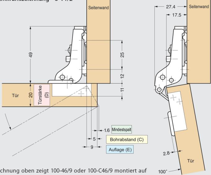
Zeichnung oben zeigt 100-46/9 oder 100-C46/9 montiert auf Montageplatte 100-P3A: Bohrabstand 5 mm, Türstärke 20 mm und 9 mm Auflage
