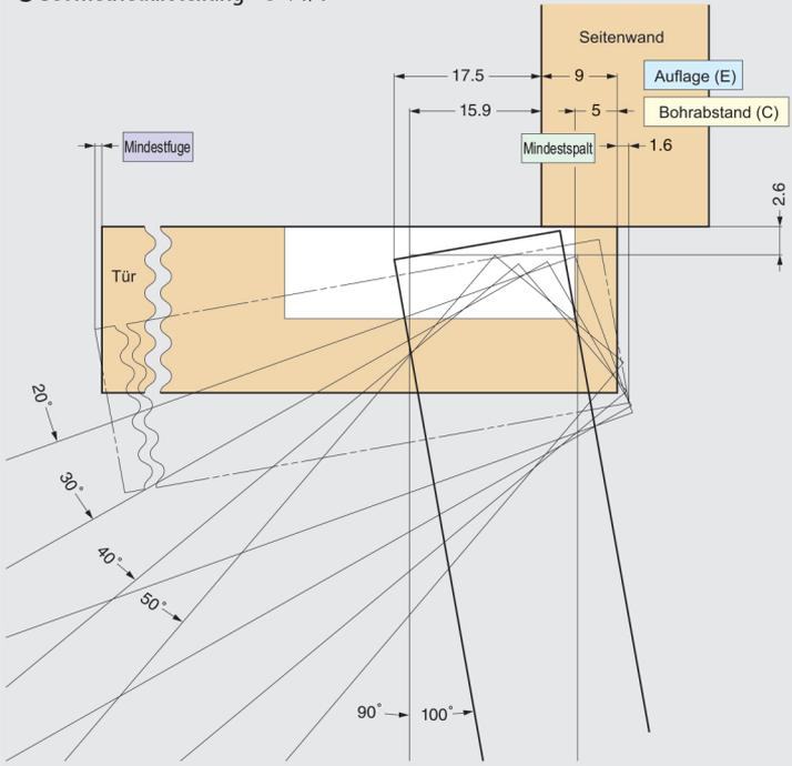
Abbildung oben mit Bohrabstand 5 mm, Türstärke 20 mm, Plattenstärke 20 mm und 9 mm Auflage
