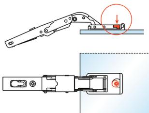
**3)** Den Topf auf die Platte positionieren und dann den Exzenter drehen.
