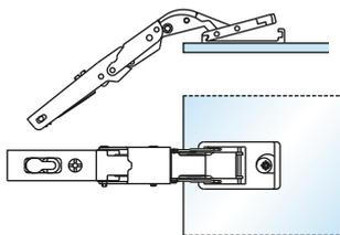
**2)** Das Scharnier montieren, wenn die Platte gut befestigt ist.
