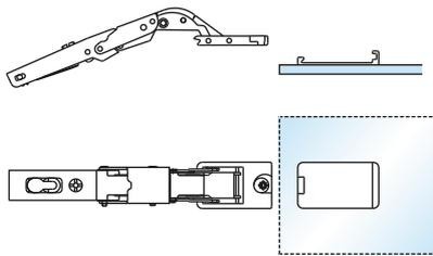
**1)** Die Platte mit einem speziellen Kleber auf der Glas- oder Spiegeltür befestigen. Es wird empfohlen, das Aufkleben von Firmen, die auf Glasverarbeitung spezialisiert sind, durchführen zu lassen. Für weitere Informationen über den Kleber und seine Anwendung können Sie sich an den Klebehersteller oder Ihren Glastür-Lieferanten wenden.
