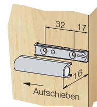
Anstatt einer stirnseitigen Bohrung im Möbelkorpus können Sie das Touch Latch Senso Element auch mit Hilfe unserer Adapterplatten, die in unterschiedlichen Ausführungen erhältlich sind, im Möbelkorpus montieren.
