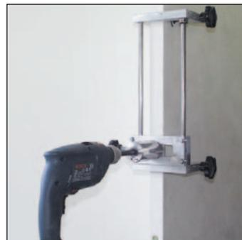
Befestigen Sie die Bohrmaschine am Schaft und fräsen Sie den Stulp oder Schlosskasten mit der höchsten Tourenzahl durch auf- und abbewegen des Schlittens. ca. 1-3 mm pro Hub
