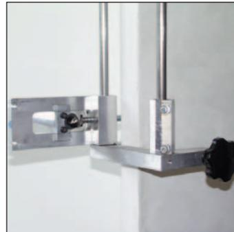
Justieren Sie den Fräser auf die richtige Distanz und befestigen Sie diesen mit den 4 Inbusschrauben.
