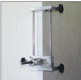
Klappen Sie den Führungsschlitten zu und befestigen Sie diesen leicht mit den Inbusschrauben.
