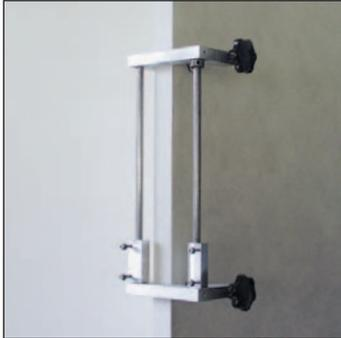
Montieren Sie das Führungsgestell an der Türe. Anschlag an der Uberschlagseite.
