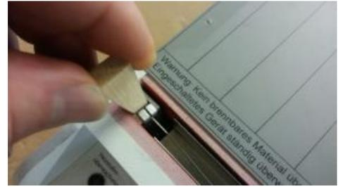
6. Ziehen Sie die Rändelschrauben beidseitig wieder an, bis der Heizdraht die gewünschte Spannung aufweist:
