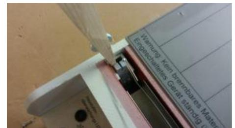
3. Führen Sie den neuen Heizdraht (Artikel-Nr. 20.712.12) bei derselben Stelle ein und stossen Sie den Keil etwas tiefer.
